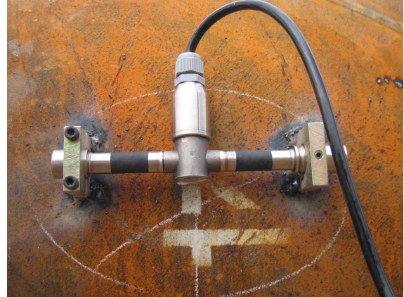
(b) 강관부 Strain Gage 설치
