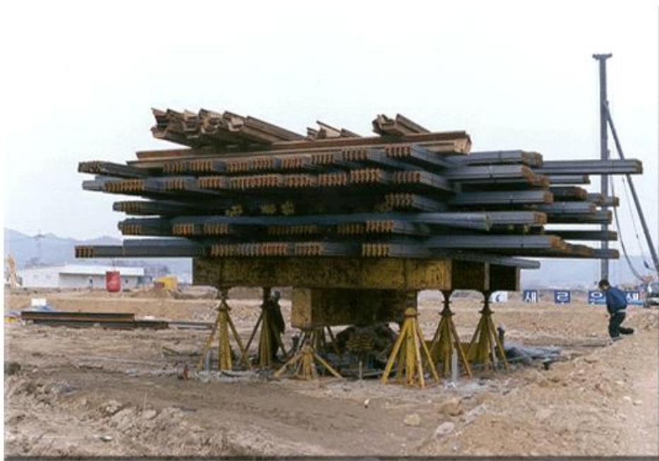
▲ 사하중을 이용한 압축재하시험
