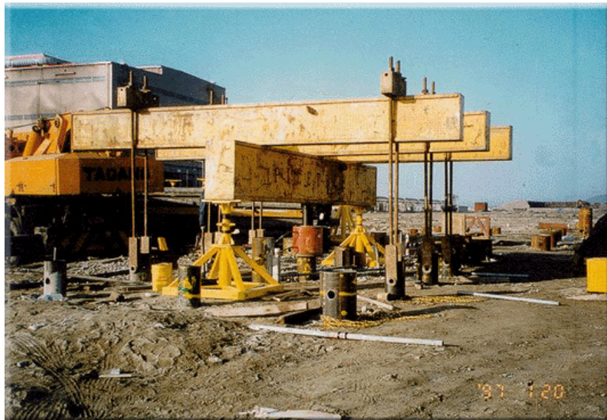
▲ 반력말뚝을 이용한 압축재하시험
